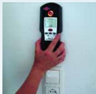
Detectare cablu activ sau pasiv (activ în mod lemn și metal, pasiv numai în modul metal)
